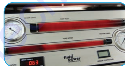
Hublots de visualisation des conduites de pression et d'aspiration
