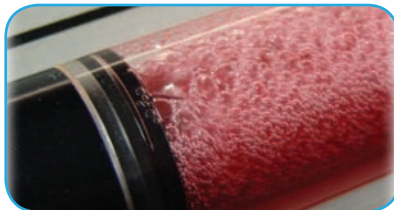
Démonstration de la cavitation et de la pseudo-cavitation causées par le ralentissement du débit ou les fuites d'air.
