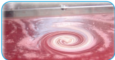
Démonstration d'un vortex causé par un niveau d'huile inadéquat ou un problème de conception.
